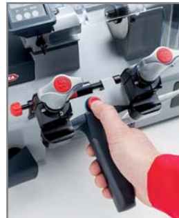
On détèle le chariot en appuyant sur un bouton dédié
